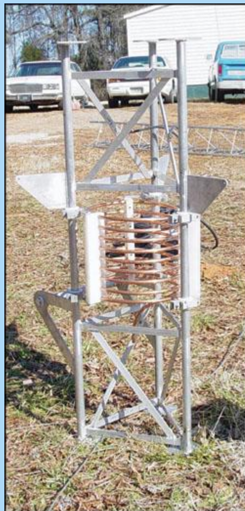
Деталь фазирующего устройства ЕН антенны
