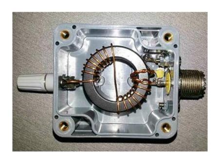
Вторичная обмотка, разделена на две разнесённые по кольцу части по 8 витков каждая. Особенность в конструкции этого трансформатора — это то, что провод первичной обмотки и провод первых двух витков вторичной обмотки перевиты между собой. Это также хорошо видно на рис. 3. Конденсатор С1 служит для коррекции частотной характеристики согласующего устройства на диапазоне 28 МГц (10 метров). Его ёмкость может быть в пределах 100…150 пФ. Он должен быть рассчитан на номинальное напряжение 1000 В.
