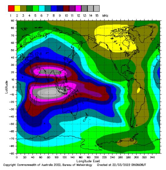
Слой F2 — самый верхний из ионизированных слоёв ионосферы. Концентрация этого слоя повышается днем, летом она выше, чем зимой. Максимальное распространение для связи одним скачком до 4000 км. Чем выше концентрация слоя, тем более высокая частота может ещё отразиться от ионосферы. Максимальная частота, при которой происходит отражение, называется максимально применимой частотой (МПЧ). С увеличением угла отражения МПЧ возрастает.
