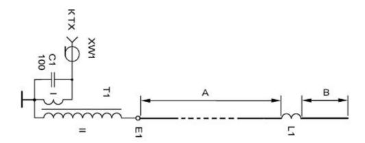
Её излучатель образован полуволновым (для диапазона 20 метров) отрезком провода, катушкой индуктивности L1 и подключённым после этой катушки сравнительно коротким отрезком провода. Индуктивность катушки L1 выбрана такой (34 мкГн), что вместе со
