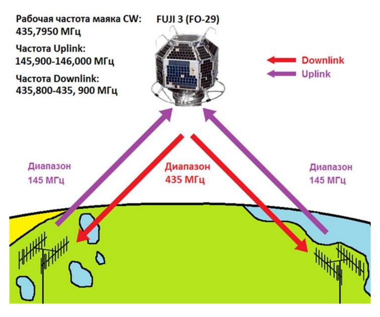
Большинство спутников оснащаются ретрансляторами примерно такого типа как УКВ репитеры. Частота приема и передачи фиксирована. Когда через спутник работает один из операторов, другие ожидают. У обычных наземных репитеров прием и передача идет на одном диапазоне с разносом частот 600кгц для 2-х метрового диапазона и 1600кгц для 70-ти сантиметрового диапазона. На спутниках устанавливаются репитеры, которые принимают сигнал на одном диапазоне, а передают на другом. Это
